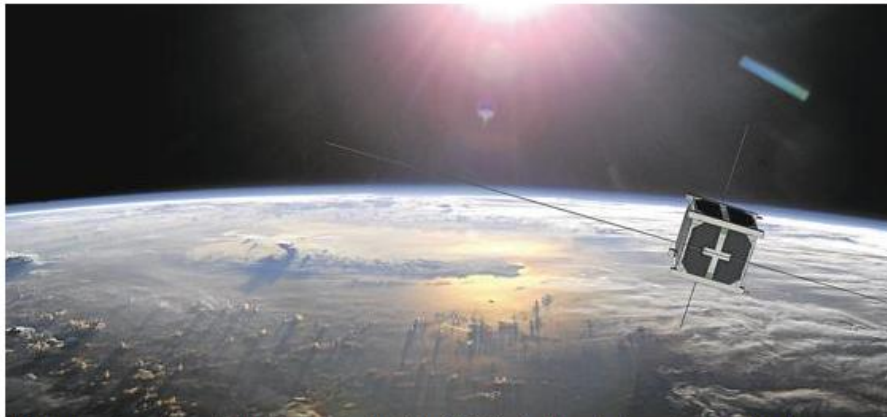
Robusta est un picosatellite (moins de 1kg) du CNES, dont la mission est de vérifier la dégradation en vol de composants électroniques en milieu radiatif spatial. Photo - DR
